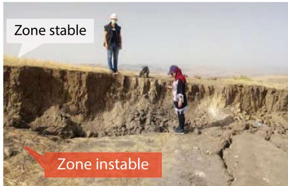
Mesure prise au niveau de la niche d'arrachement principale
